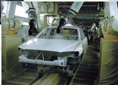
Rampe de peinture de revêtement de voiture
